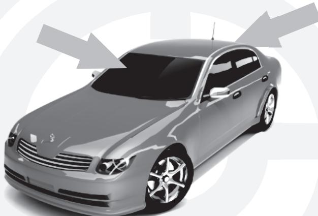
GPS-антенну необходимо установить скрытно, под пластиковым (не экранирующим) элементом обшивки салона. Если стекло автомобиля над местом установки имеет тонировку, необходимо учитывать, что качество приема сигналов может ухудшиться.
