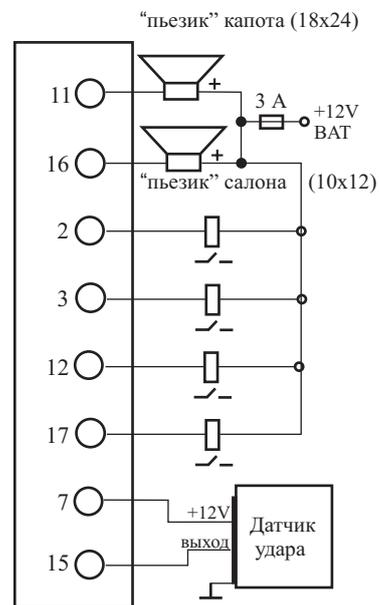
Все "слаботочные" выходы восемнадцатиконтактного разъёма (2,3,4,8,9,11,12,17,18) рассчитаны на ток не более 150 мА.
